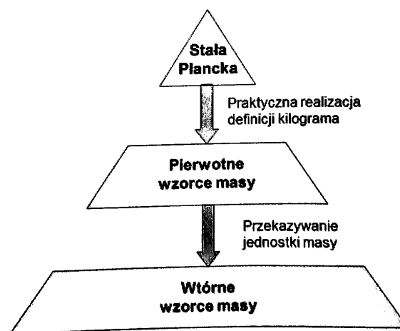
Rys. 4. Spójność pomiarowa po redefinicji jednostki miary masy [12]
